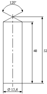
Afb. 2 : Cilindervormige bronzen zuiger (afmetingen in mm)
